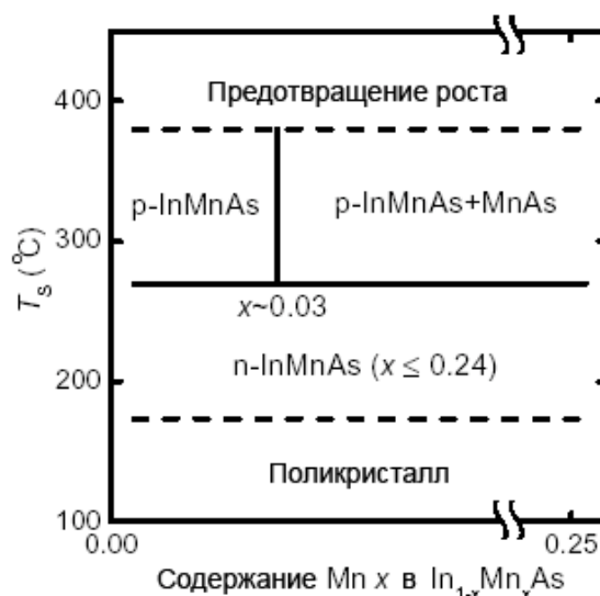
Рис.3.2. Схематическая диаграмма свойств пленок (In,Mn)As, выращенных прямо на подложке GaAs, в связи с параметрами их выращивания
