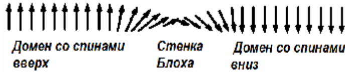
Рис.2.12. Схема, иллюстрирующая ход изменения направления спинов в стенке Блоха между доменами с противоположными направлениями намагниченности
