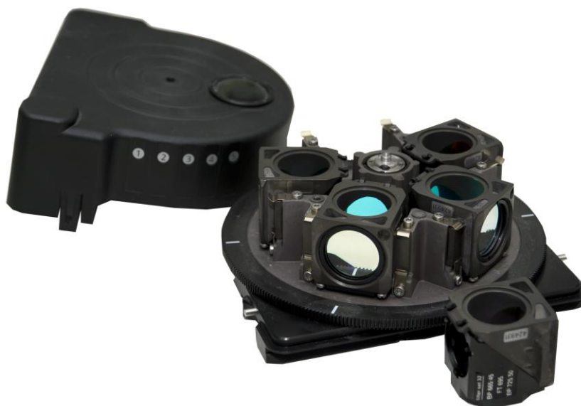
Рис. 16. Фильтровый блок микроскопа Axiovert 200. Крышка блока снята, справа показан единичный фильтровый кубик
