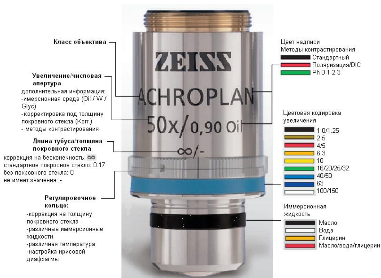
Рис. П2-1. Маркировка объективов производства Carl Zeiss
