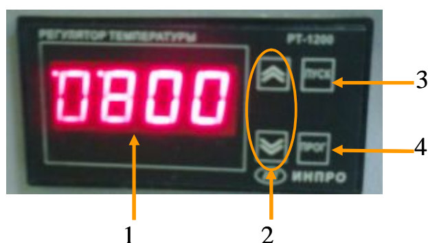
Рис. 21. Панель управления регулятора температуры РТ-1200: 1 – индикатор значений текущей температуры и значения времени участка регулирования температуры в минутах, 2 – кнопки установки необходимых значений, 3 – кнопка перехода из дежурного режима в автоматический (ПУСК), 4 – кнопка ввода термической программы (ПРОГ).
