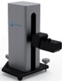
Рис. 2. Микроскоп для наблюдения под углом Брюстера за состоянием монослоя
