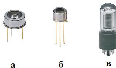
Рис. 28. Внешний вид детекторов: а – PbS, б – InGaAs, в – ФЭУ
