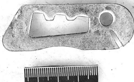
Изображение 3. Первая сувальда из механизма замка
