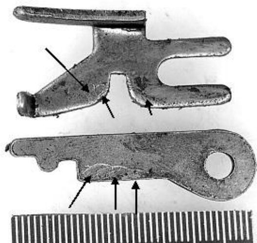
Изображение 3. Ригель замка и вторая сувальда. Стрелками отмечены следы постороннего предмета
