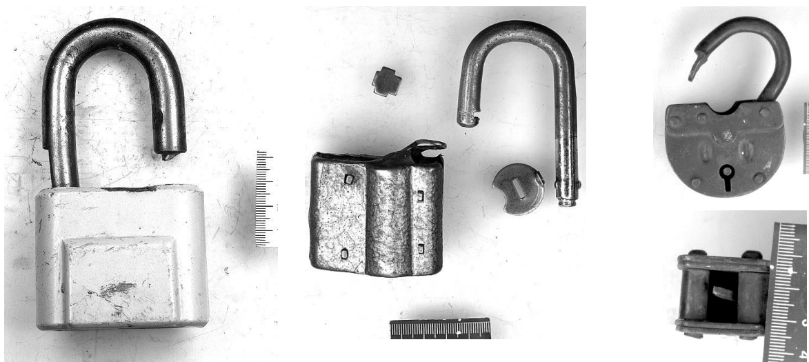
Замки, взломанные путем отжатия дужки.
