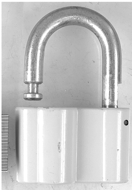
Изображение 35. Замок, взломанный путем удаления запирающего механизма
