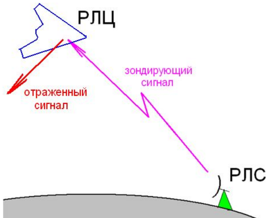
Рис. 16. Случай зеркального отражения ЭМВ от цели.
