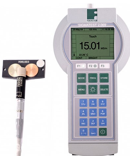
Рис. 8. Прибор для измерения электропроводности SIGMATEST 2.069
