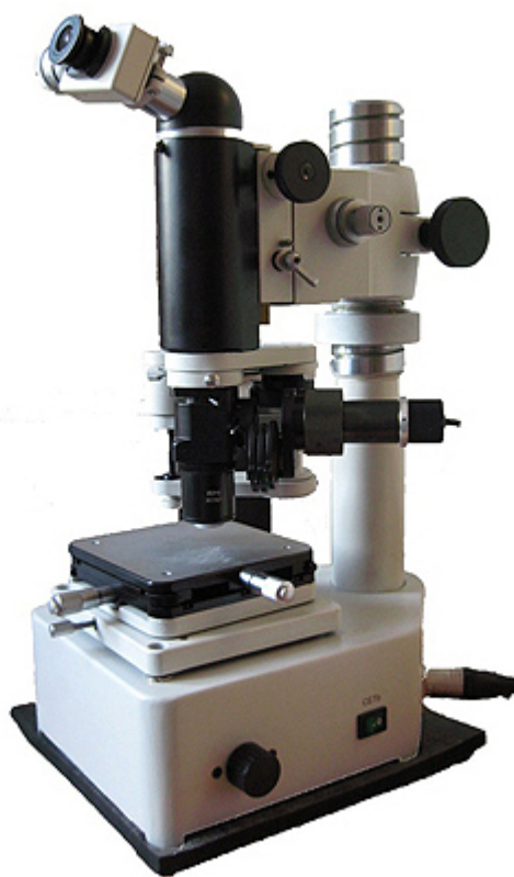
Рис. 7. Общий вид микротвердомера ПМТ-3
