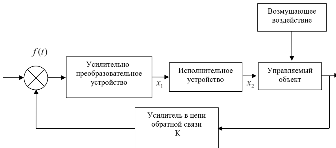
Рис.2.1 Функциональная схема замкнутой системы
