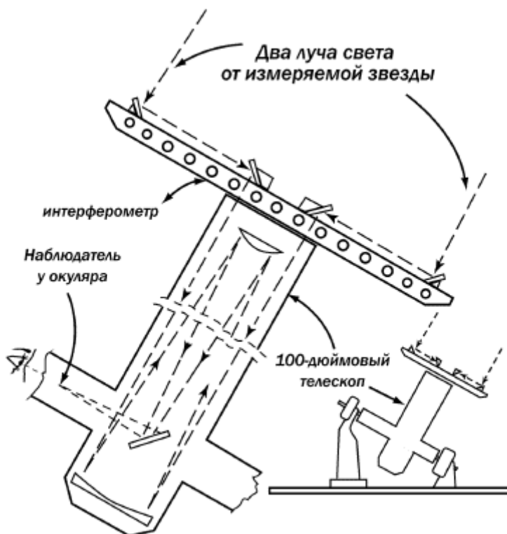
Рис. 3 Схема установки, поясняющей устройство прибора интерферометра для измерения угловых диаметров звезд
