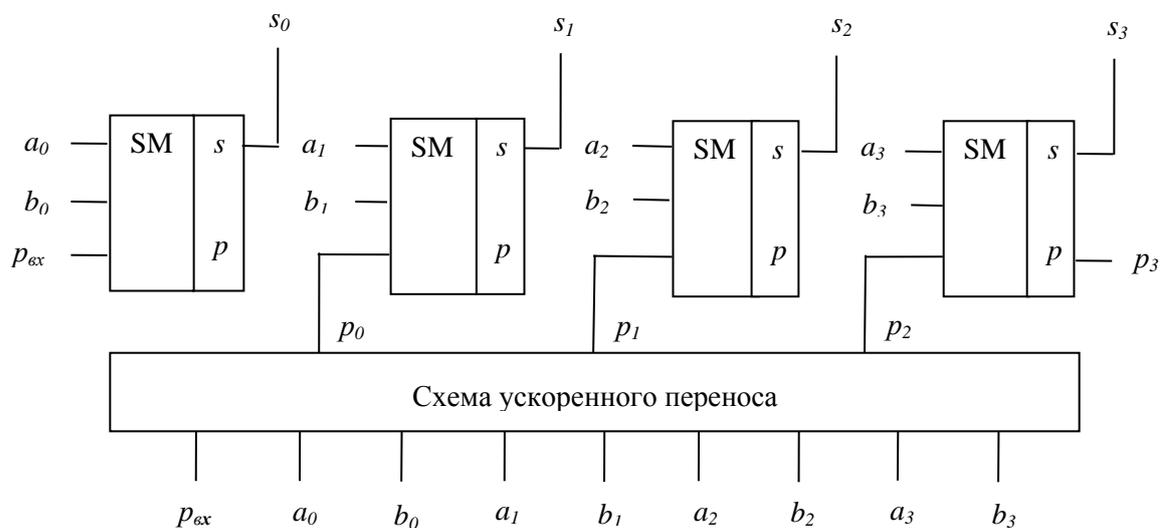
Рис. 3.12. Структура четырехразрядного сумматора с параллельным переносом
