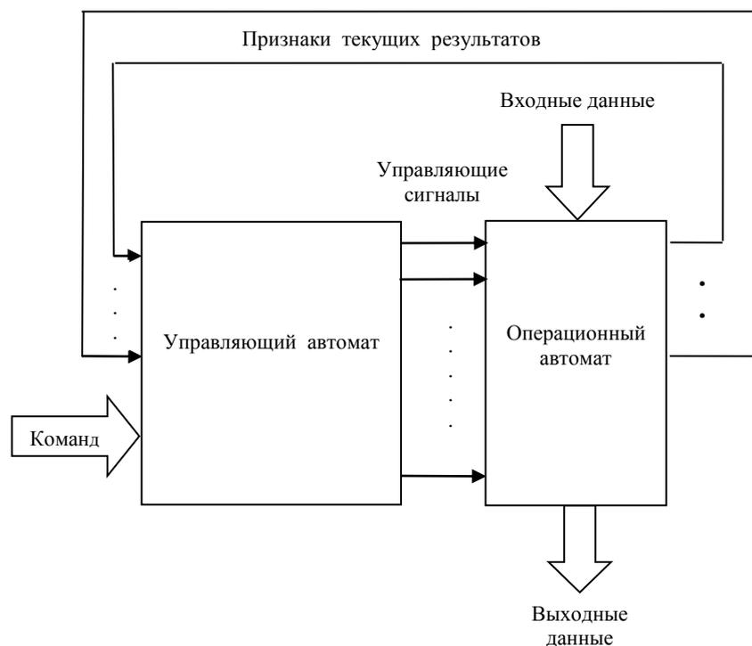
Рис. 5.1. Каноническая схема процессора
