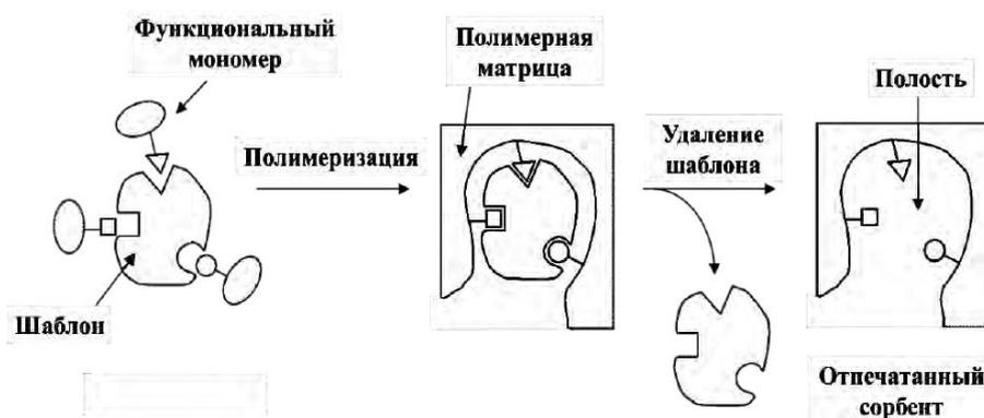
**Рисунок 28.** Схематическое представление принципа молекулярного импринтинга
