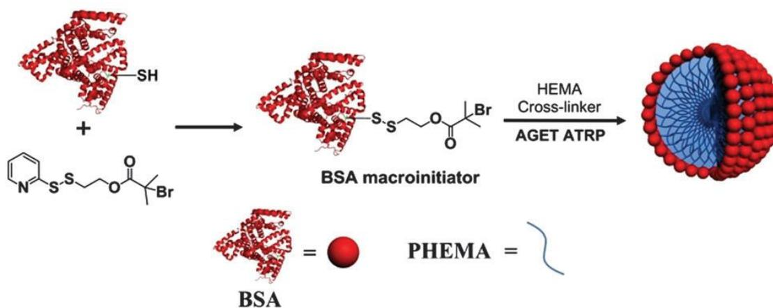
**Рисунок 56.** Схематическое изображение приготовления частиц полимер-белковое ядро-корона с помощью активаторов, генерируемых переносом электрона для радикальной полимеризации с переносом атома. PHEMA - поли(2-гидроксиэтилметакрилата), BSA - бычий сывороточный альбумин [3.2]
