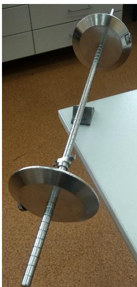
Рис. 11. Определение положения центра масс оборотного маятника на призме-подставке: a – общий вид, b – схема ( O – точка подвеса, K – центр качаний)
