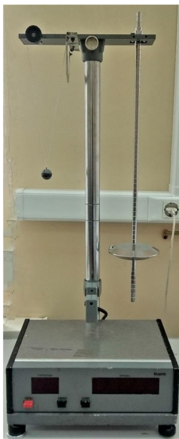
Рис. 5. Экспериментальная установка: a – общий вид; b – элементы конструкции физического маятника
