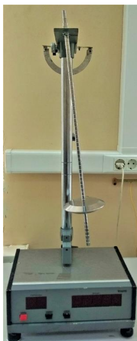
Рис. 9. Физический маятник вида «стержень-диск»
